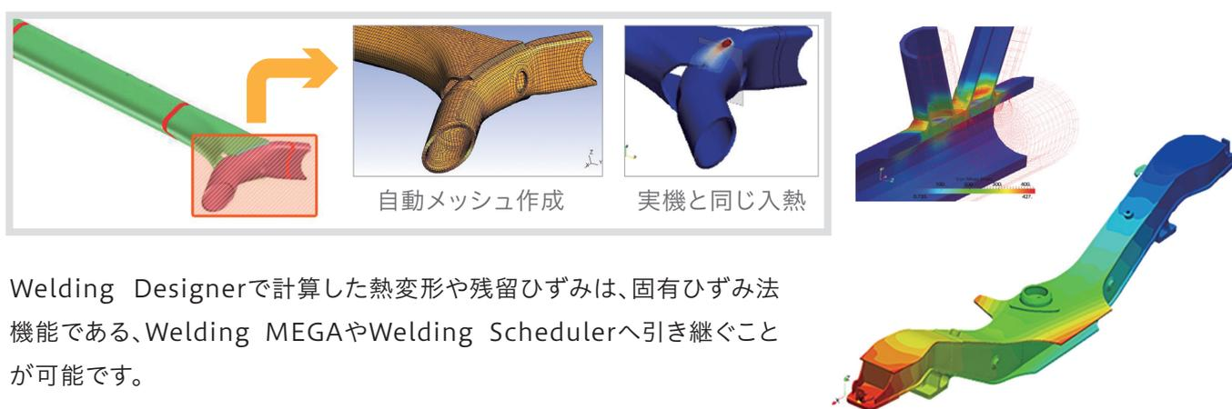
Welding Designerで計算した熱変形や残留ひずみは、固有ひずみ法機能である、Welding MEGAやWelding Schedulerへ引き継ぐことが可能です。
