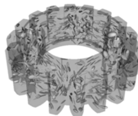
図2 シミュレーションによって予測された3次元繊維配向分布（伸びた楕円体＝強い配向を表す）
